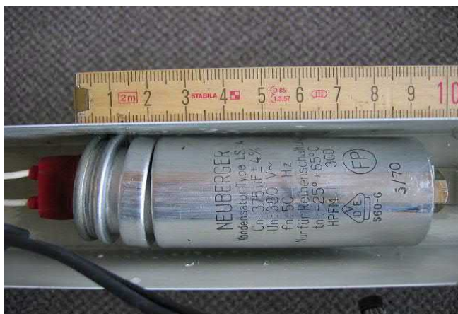
Abb. 5: Kondensatoren: Ein typisches Anwendungsfeld von PCB
